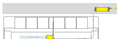
Sonde d'eau dans le climatiseur, pompe dans le plafond.
